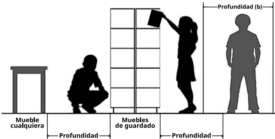
Ilustración 5 - Separaciones mínimas para muebles de guardado
